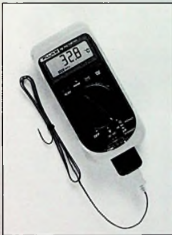
De digitale multimeter Fluke 16 meet onder meer temperaturen van -40°C tot +400°C
